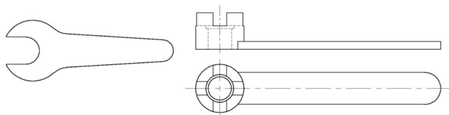
**für Spindelköpfe mit Fräseraufnahme und Kühlsmierstoffzuführung extern***- for spindle units with shell end milling cutter and coolant supply external**- pour unités broches avec adaption pour fraises et alimentation d'arrosage extérieur*
